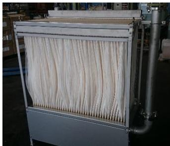
Der biologische Reinigungsprozess findet in dem MBR-Behälter statt. Die Biomasse in Form von Belebtschlamm wird hundertprozentig an der Membran zurückgehalten, sodass das
